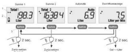
Genom att trycka på knappen kan man koppla om till de olika indikeringslägena. På mätindikatorns display kan följande information visas.
