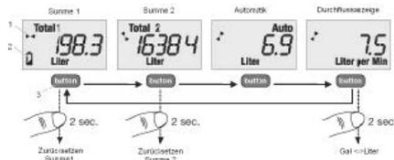
С кратко натискане на бутона може да се превключи на различни индикации. На дисплея на индикатора със стрелки може да бъде показано следното:
