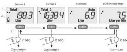
Durch kurzes Drücken des Buttons kann in die verschiedenen Anzeigen umgeschaltet werden.
