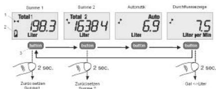
Premendo breve il pulsante è possibile commutare nelle diverse visualizzazioni. Nel display del minimetro può essere visualizzato quanto segue:
