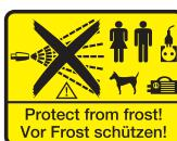
Mlazovi pod visokim pritiskom mogu kod nestručne upotrebe biti opasni. Mlaz se ne sme da usmerava prema ljudima, životnjama, aktivnoj električnoj opremi ili samom uređaju.
