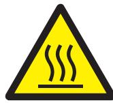
*Risque de brûlure provoqué par les pièces chaudes de l'installation !*
